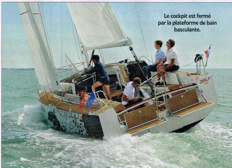
Le cockpit est fermé par la plateforme de bain basculante.
