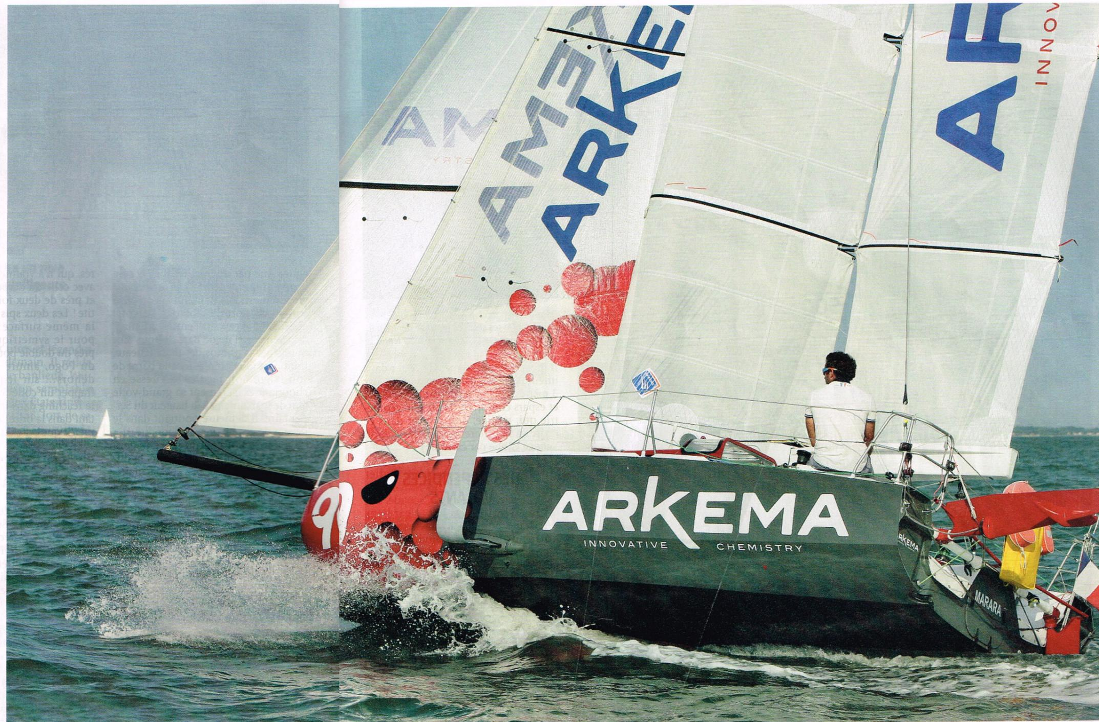
J'ai eu le privilège d'embarquer avec Quentin Vlamynck pour une navigation sur le mini 6,50 Arkema de l'équipe Lalou Multi, qui rassemble à son bord un condensé des dernières innovations en course au large : foils rétractables, aile souple arisable, carène de scow, matériaux de construction thermoplastique, ergonomie... Romaric Neyhousser, l'architecte du n° 900, a «pondu» là un petit bolide qui sort intégralement des sen-
