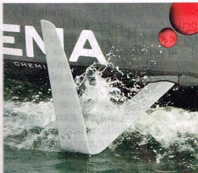
**Zoom.** Le foil tribord intégralement sorti, avant d'être plongé dans l'eau grâce à un ingénieux système de bascule vers le bas. L'extrémité : «le tip» est la partie porteuse.
