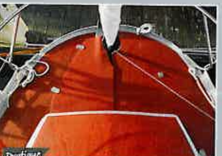
Pratique L'ensemble du pont et le rouf ont reçu un antidérapant en liège très efficace.
