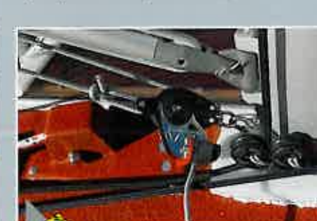
Pas pratique Le taquet de hale-bas est mal orienté, il est difficile de libérer la manœuvre.
