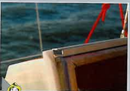
Pas pratique La finition de la glissière de capot de descente est un peu agressive.
