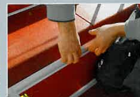
Pas pratique Pas facile d'ouvrir les coffres du cockpit faute de poignée.
